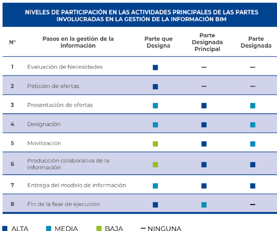
Figura 2.- Actividades de las inversiones en función de agentes. Origen: Guía Nacional Plan BIM Perú.
