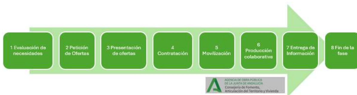
Figura 14.- Etapas de desarrollo de información en fase de desarrollo. Origen: UNE-EN ISO 19650
